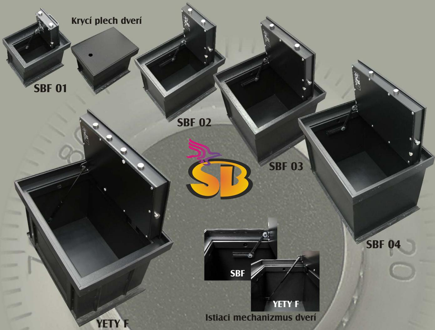
Trezory sú prispôsobené na zamurovanie do podlahy vrstvou betónu. Sú vyrábané s rôznymi kombináciami trezorových zámkov s madlom na dverách. Na čelnej strane sú vybavené rámčekom s odnímateľným krycím plechom dverí. Dvierka trezorov SBF sú v otvorenej polohe zabezpečené istiacim mechanizmom a dvierka trezorov YETY F sú vybavené pneumatickým zdvívacím zariadením.
